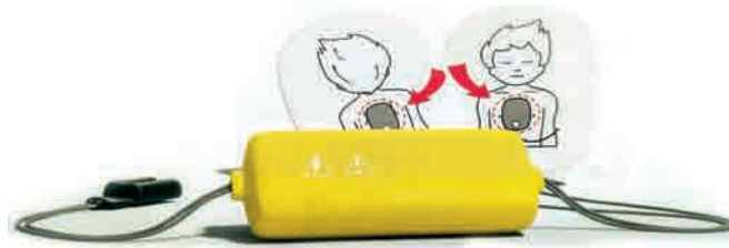
شکل ۸. نمونه‌ای از یک کاهش دهنده دوز کودکان، که دوز شوک ارائه شده توسط یک AED را کاهش می‌دهد. پدهای کودکان هم با این کاهش دهنده استفاده می‌شوند.
